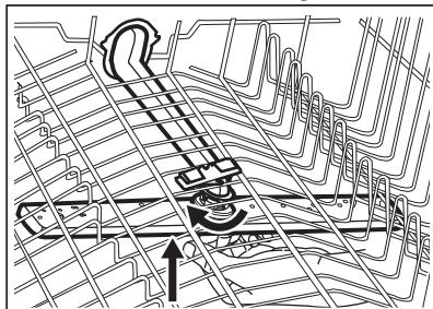
3. Umyć ramię spryskujące pod bieżącą wodą. Za pomocą spiczastego przedmiotu, np. wykałaczki, usunąć zabrudzenia z otworów.
