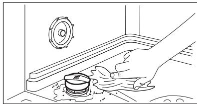
6. Csavarja vissza a kupakot az óramutató járásával megegyező irányban a sótartály bezárásához.
