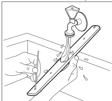
5. A szórókar (**C**) visszaszereléséhez helyezze a rögzítőgyűrűt (**B**) a szórókarba, és az óramutató járásával megegyező irányba való elforgatással rögzítse a vízbevezető vezetékhez (**A**). A rögzítőgyűrűt ütközésig csavarja be.
