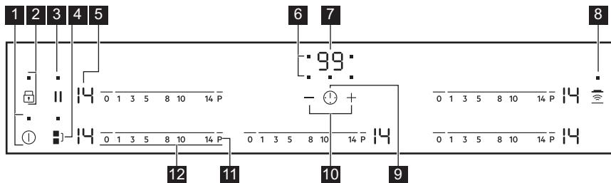
Folosiți câmpurile cu senzori pentru controlul aparatului. Afisajele, indicatoarele și semnalele sonore indică funcțiile active.
