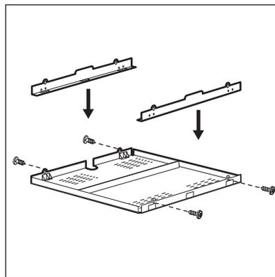
Po zamontowaniu kasety ochronnej (wyposażenie dodatkowe) nie ma konieczności montażu przegrody zabezpieczającej bezpośrednio pod płytą grzejną. Akcesoria ochronne mogą być
