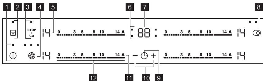
K ovládání spotřebiče používejte sensorová tlačítka. Displeje, ukazatele a zvukové signály signalizují, jaké funkce jsou zapnuté.
