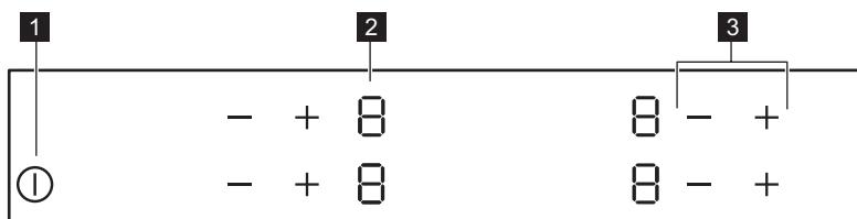
Pentru a utiliza aparatul folosiți câmpurile cu senzori. Indicatoarele și afișajele prezintă funcțiile active.
